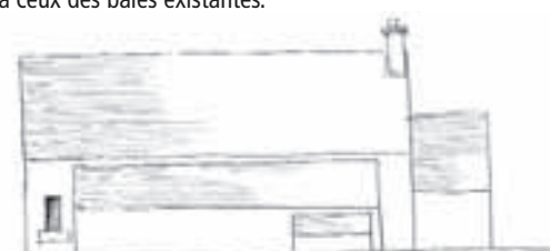
La façade nord n'est pratiquement pas ouverte. Des annexes se sont implantées sur cette façade, renforçant ainsi son isolation thermique.
